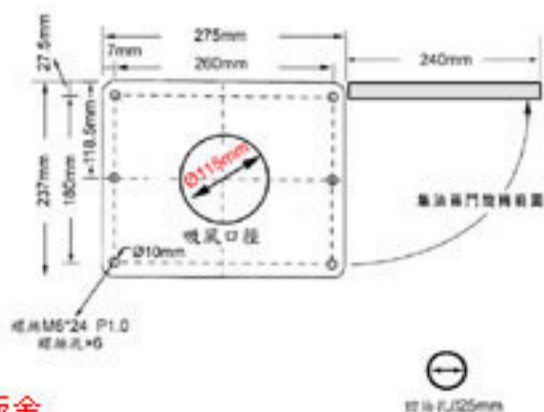
機台裝配尺寸圖(固定集油箱用)
